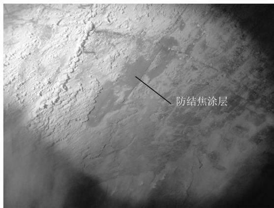
1. 一种危废焚烧系统急冷塔用防腐蚀防结焦涂料,其特征在于,由以下重量百分比的原料组成:纳米金刚石粉35-50%、纳米氧化铬10-15%、纳米硼化锆粉5-10%、硼化硅微粉5-10%以及结合剂20-30%。
